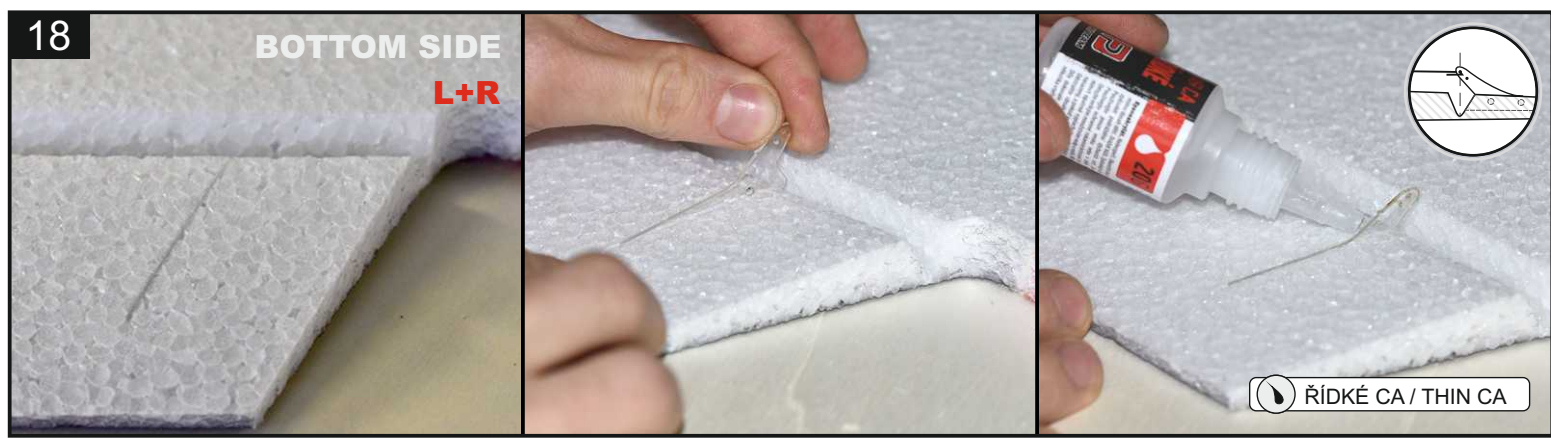
Glue wooden motor mount(M1) and install the engine(M2). Glue the fuselage(F) with Thin CA. Přilepte dřevěnou mot.přepážku(M1) a instalujte motor(M2). Přilepte trup(F) za pomoci řídkého CA.
