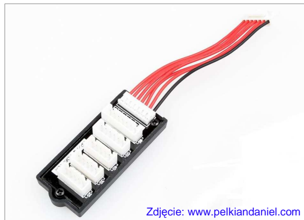
Adapter balansera z przejściówką (System RAY/PolyQuest)
